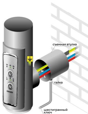
Схема 2. Подключение при помощи кабель-вилки
