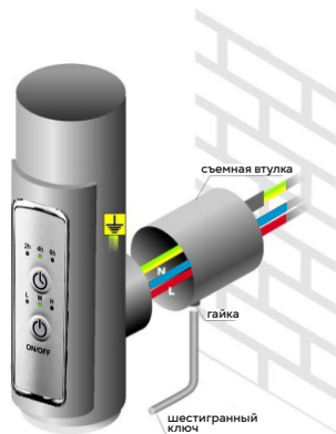
Схема 1. Подключение к скрытой проводке
