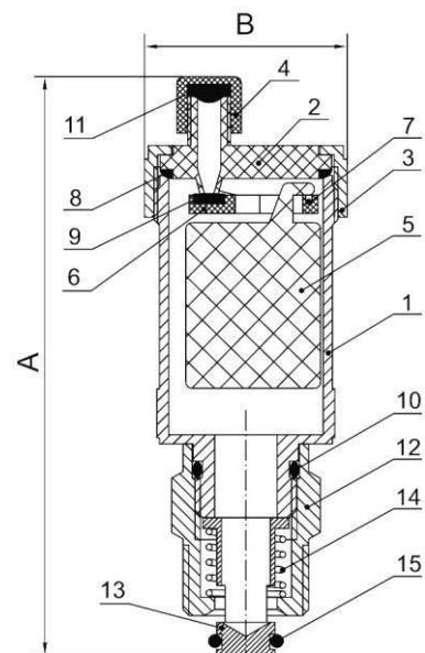
В корпусе отсекающего клапана (12) расположен отсекающий элемент (13) с уплотнительным кольцом (15). Корпус имеет в верхней части отверстие для присоединения клапана к воздухоотводчику с внутренней резьбой диаметром 3/8" и в нижней части — отверстие для присоединения изделия к системе с наружной резьбой 1/2".
