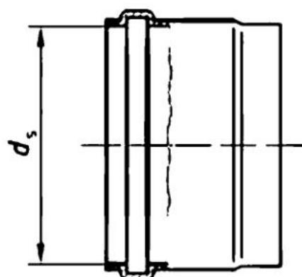
Рисунок 10 – Патрубок для стыковой сварки
