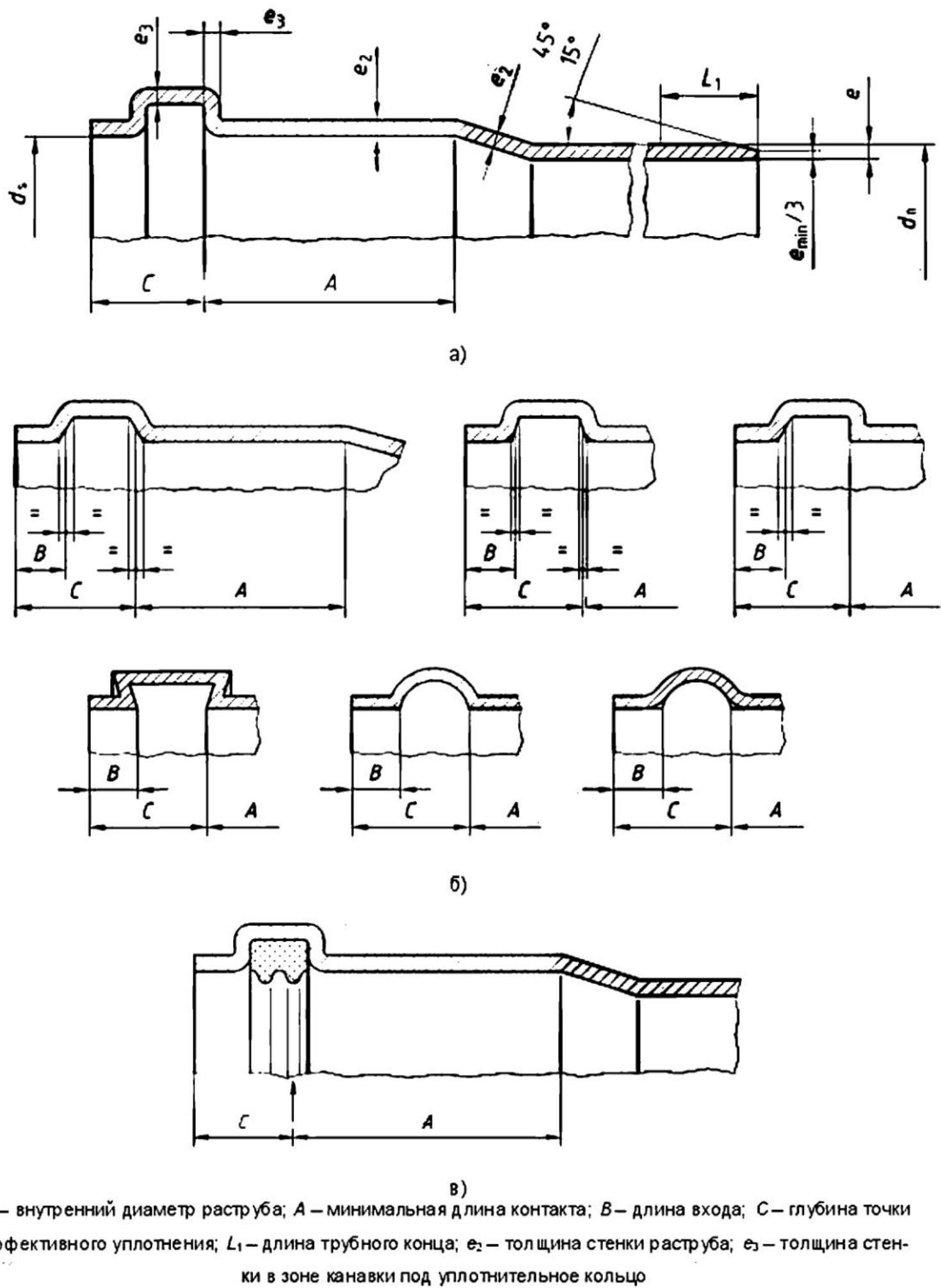
$d_s$  – внутренний диаметр раструба;  $A$  – минимальная длина контакта;  $B$  – длина входа;  $C$  – глубина точки эффективного уплотнения;  $L_1$  – длина трубного конца;  $e_1$  – толщина стенки раструба;  $e_3$  – толщина стенки в зоне канавки под уплотнительное кольцо
