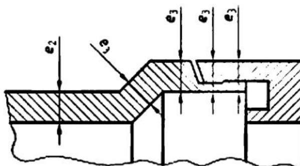
Рисунок 3 – Толщина стенки раstrуба с крышкой для установки уплотнительного кольца
